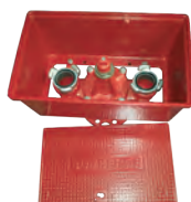
Serie 88/10 Hidrante enterrado con arqueta y tapa DN100 PN16 Fundición dúctil 2 x 70 Racor Barcelona UNE 23400 Opciones: • Sin arqueta y tapa • Con marco y tapa
