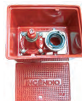
Serie 88/20 Hidrante enterrado con arqueta y tapa DN80-100 PN16 Fundición dúctil Racor Storz Opciones: • Sin arqueta y tapa • Con marco y tapa
