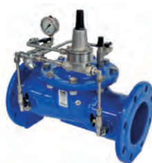
Serie 879 Válvula de control Sostenedora o Aliviadora de presión DN50-600 PN10/16 Fundición dúctil/AISI 316
