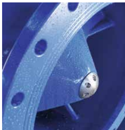
Revestimento epóxi aplicado em pó que funde após o contato com a superfície pré-aquecida com espessura min. 250 µm.
