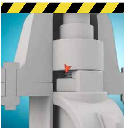
La mayoría de las válvulas de compuerta están diseñadas con una tuerca suelta localizada en un alojamiento tipo “bayoneta”, donde es difícil vulcanizar suficientemente de caucho. La tuerca suelta vibra cuando está merced del caudal lo que conlleva a la abrasión de la fina capa de caucho.
