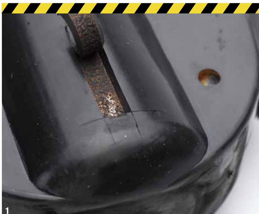
Un test de adhesión muestra una incorrecta unión en una compuerta de la competencia (#1). Esto puede ser provocado por una elección incorrecta del método de unión o un proceso erróneo.
