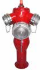
Serie 78 Hidrante de columna seca Profundidad enterrada 1000, 1250, 1500 mm PN 16 DN 80-100 Fundición dúctil Salidas racor Storz Certificado EN 14384
