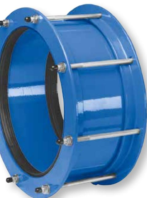
La gama AVK de accesorios fabricados consta de uniones, reducciones y bridas enchufe DN 350-2000 (no antitracción) La gama es adecuada para la fundición dúctil y gris, acero, uPVC, tuberías de poliéster de fibra de vidrio (PRFV) aplicaciones para agua y aguas residuales de hasta 25 bares.
