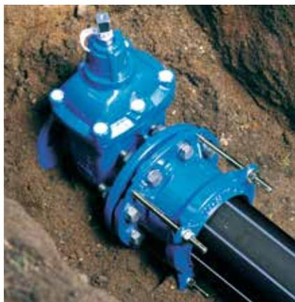
Con su gran tolerancia y su desviación angular de  $\pm 4^\circ$  en cada lado, la gama Supa® de AVK es un sistema de acoplamiento muy flexible que se utiliza para montar las tuberías de casi cualquier tipo de material y para reparar los sistemas de tuberías viejos.
