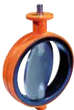
Serie 75/11 Mariposa concéntrica asiento vulcanizado al cuerpo de NBR Fundición dúctil Varios tipos de accionamientos
