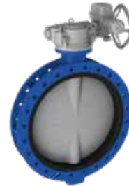
Serie 820/20 Mariposa concéntrica con asiento NBR Sección en U Fundición dúctil DN25-1600 Varios tipos de accionamientos
