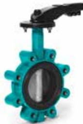
Desponia® Mariposa concéntrica con asiento NH o FPM VD Lug Fundición dúctil DN25-600 Varios tipos de accionamientos
