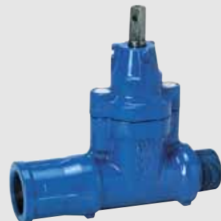
Serie 03/40 – Unión mixta, rosca macho / enchufe autoblocante para tubos de PE.
