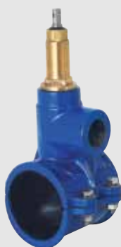
Serie 727/09: Collarín de toma en carga SWIC para tubos de PE y de PVC con cuchilla de corte integrada, DN 50-225, BSP ½-2"
