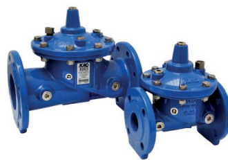
Serie 879 Válvula de control de diafragma DN50-600 PN10/16 Fundición dúctil Diafragma EPDM
