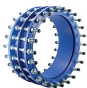
Serie 873/00-001 Carrete de desmontaje con brida central DN40-2600 PN10/16/25 Fundición dúctil Caucho EPDM Varillas acero 8.8 cincado
