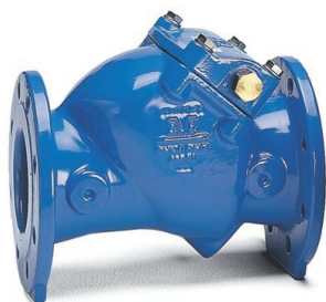
Serie 41/61-003 Válvula de retención de clapeta oscilante Asiento elástico Eje ciego DN50-600 PN10/16 Fundición dúctil
