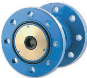
Serie 712 Limitador de flujo de limpieza automática con bridas y anillo único DN50-150 PN10 Fundición dúctil Placa latón Caucho NBR
