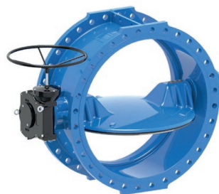
Serie 756/218-001 Válvula de mariposa doble excéntrica EN 558-2, serie 13, corto DN700-1200 PN10/16 Fundición dúctil Eje inoxidable Caucho EPDM
