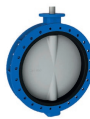
Serie 820/20-025 Válvula de mariposa concéntrica Sección en U EN 558-1, serie 20 DN150-1600 PN10/16 Fundición dúctil Disco AISI 316 Junta EPDM Opcional: Disco fundición dúctil revestido de rilsan
