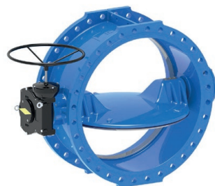
Serie 756/118-011 Válvula de mariposa doble excéntrica EN 558-2, serie 14, larga DN700-2400 PN10/16 Fundición dúctil Eje inoxidable Caucho EPDM
