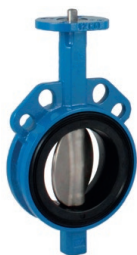
Serie 820/00-025 Válvula de mariposa concéntrica Wafer EN 558-1, serie 20 DN25-1000 PN10/16 Fundición dúctil Disco AISI 316 Junta EPDM Opcional: Disco fundición dúctil revestido de rilsan
