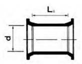
DESCRIPCIÓN: Manguito E/E de Junta Mecánica en fundición dúctil según EN545
